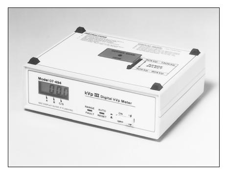
Figure 1-1. Model 07-494 Wide-Range Digital kVp Meter
